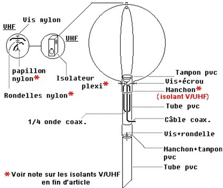
Pour ne pas surcharger le dessin, le plan de masse n'est pas représenté. Il est constitué de 8 radians aluminium, connectés à la masse en un seul point central éventuellement recouverts de grillage type "moustiquaire" en aluminium et sera ajouté sur le tube PVC supportant l'antenne. Les radians peuvent aussi être fixés autour du tube PVC par un collier inox.
